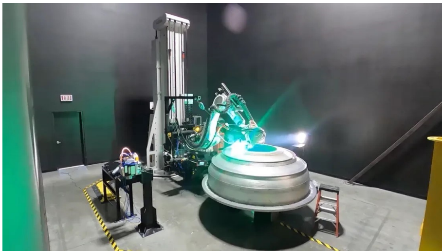
Сл. 7. 3D-печатење на резервоар за гориво за ракетен мотор во напреден стадиум
