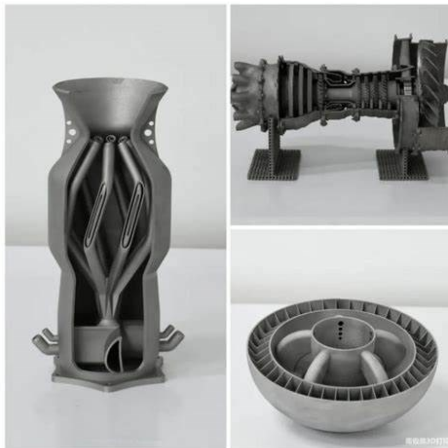
Сл. 2. Пример за структури кои не можат да се добијат со класични производствени методи
