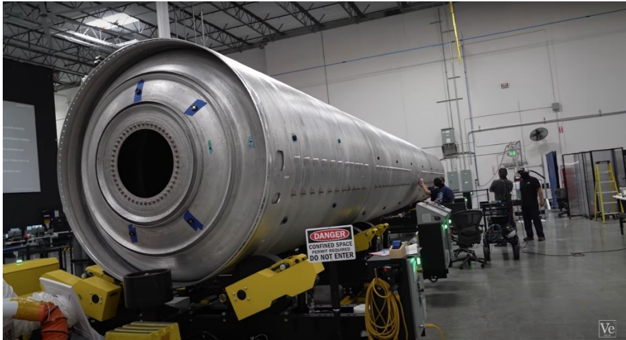
Сл. 5. 3D-печатен труп за ракета во кој е вметнат и резервоарот за гориво
