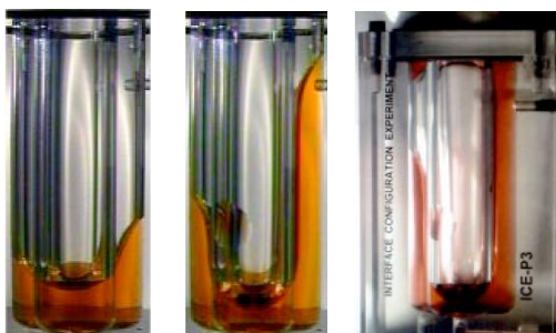
Сл. 12 Облик на површината на течноста кај садот 38^\circ/44^\circ . Левата слика е снимена веднаш по полнењето, сликата во средина после серија протресувања на садот, а десната слика е снимена седум дена после сликата во средина. Превземено од [5].
