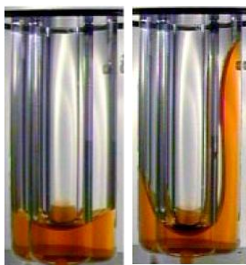
Сл. 11 Облик на површината на течноста кај садот 30^\circ/36^\circ . Левата слика е снимена веднаш по полнењето, а десната после серија протресувања на садот. Превземено од [5].
