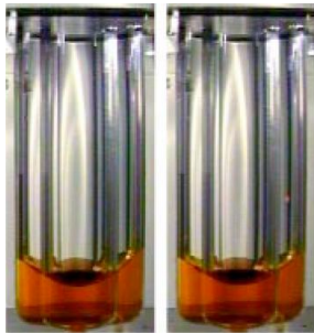
Сл. 10 Облик на површината на течноста кај садот 20^\circ/26^\circ . Левата слика е снимена веднаш по полнењето, а десната после серија протресувања на садот. Превземено од [5].
